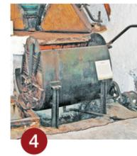
**Batidora:** El interior de la batidora presenta un sinfín en espiral giratorio que remueve la pasta. La pared interna está recubierta por una chapa de ladrillo que mantiene la temperatura templada. En la parte superior se ubicaba un termómetro, el cual debía estar a unos 30°C aproximadamente para facilitar la extracción del componente graso de la pasta.
