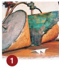
**Rulos:** Parte activa de la molturación, de forma cónica que, con su pesada estructura, al girar, trituraba las olivas transformándolas en una pasta. El rulo empujaba la oliva triturada hacia fuera, hacia la reguera; una especie de canal que bordeaba el extremo exterior de la solera, donde se almacenaba provisionalmente la pasta.
