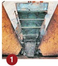
**Tolva:** Estructura troncocónica de madera invertida que servía para dosificar la cantidad de olivas a molturar. Las aceitunas caían directamente de la tolva a la solera, una estructura de forma cilíndrica, recubierta de piedra por la cara anterior, con una altura de dos o tres palmos del nivel del suelo.
